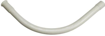
**Caractéristiques techniques**Forme **courbe**Diametre Nominal **32**Ø PVC (mm) **63**Rayon (mm) **500**
