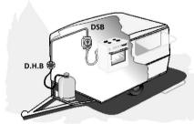
Cet appareil permet d'alimenter une installation à partir d'une seule bouteille de butane placée à l'extérieur.
