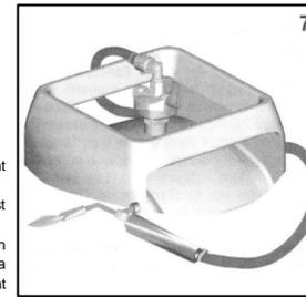
Dans le cas d'un appareil d'utilisation directement raccordé au Cube (Fig.7) utiliser un flexible haute pression (pression d'utilisation 20 bar). Pour une application domestique il est obligatoire d'utiliser un flexible conforme à la norme NF M88-768 ou NF M88-780.
