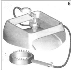
Dans le cas où l'appareil d'utilisation nécessite un détendeur (Fig.6) vérifiez ses caractéristiques de fonctionnement :
