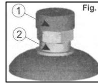
Il se monte exclusivement sur une bouteille de PROPANE ou BUTANE BUTAGAZ. Celui-ci est équipé d'une valve de Ø27mm (2). N'essayez jamais de le monter sur des valves de Ø différent ou sur des valves ou robinets d'un autre type.
