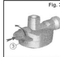
Une fois l'adaptateur correctement monté sur la valve, l'arrivée du gaz s'obtient en tournant la manette (3) du robinet vers le haut (sens contraire des aiguilles d'une montre). Agir inversement pour fermer l'arrivée du gaz, la flèche gravée sur la manette indique le sens de fermeture. (Fig.3)
