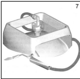
Dans le cas d'un appareil d'utilisation directement raccordé au Cube (Fig.7) utiliser un flexible haute pression (pression d'utilisation 20 bar). Pour une application domestique il est obligatoire d'utiliser un flexible conforme à la norme NF M88-768 ou NF M88-780.
