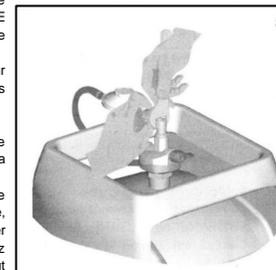
Raccordez l'appareil d'utilisation sur la sortie de l'adaptateur en maintenant ce dernier avec une contre clé (Fig. 5). Le raccordement sur le filetage 21.7mm à gauche doit s'effectuer à la main
