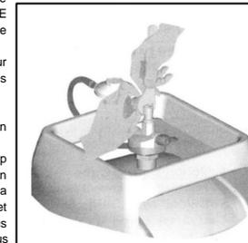
Raccordez l'appareil d'utilisation sur la sortie du Clip Direct en maintenant ce dernier avec une contre clé (Fig. 5).
