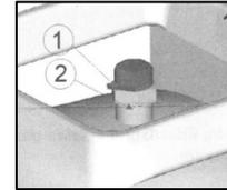
Il se monte exclusivement sur le Cube de PROPANE ou BUTANE BUTAGAZ. Celui-ci est équipé d'une valve de Ø27mm (2). N'essayez jamais de le monter sur des valves de Ø différent ou sur des valves ou robinets d'un autre type.
