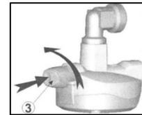
Une fois le Clip Direct correctement monté sur la valve, l'arrivée du gaz s'obtient en tournant la manette (3) du robinet vers le haut (sens contraire des aiguilles d'une montre). Agir inversement pour fermer l'arrivée du gaz, la flèche gravée sur la manette indique le sens de fermeture. (Fig.3)
