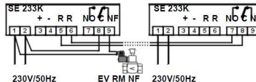
Raccordement avec électrovanne à réarmement manuel normalement fermée 230Vca (relais normalement excité) et un second détecteur SE233K (ou un SE 296 K).
