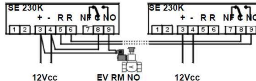
Raccordement avec électrovanne à réarmement manuel normalement ouverte 12Vcc (relais normalement désexcité) et un second détecteur SE230K (ou un SE 296 K).
