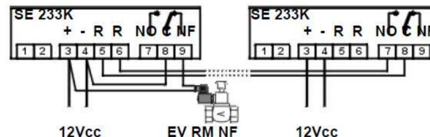
Raccordement avec électrovanne à réarmement manuel normalement 12Vcc (relais normalement excité) et un second détecteur SE233K (ou un SE 296 K).
