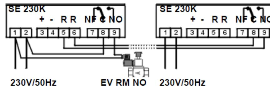
Raccordement avec électrovanne à réarmement manuel normalement ouverte 230Vca (relais normalement désexcité) et un second détecteur SE230K (ou un SE 296 K).
