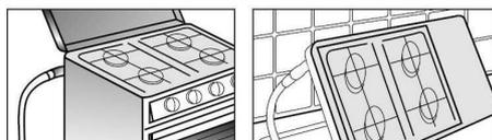
SEREINGAZ est constitué d'un tuyau flexible métallique onduleux en acier inoxydable, couvert d'une tresse métallique inox et d'une gaine en PVC.
