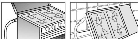
**SEREINGAZ BP** est constitué d'un tuyau flexible métallique onduleux en acier inoxydable, couvert d'une tresse métallique inox et d'une gaine en PVC.
