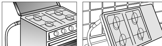
**NATURE** est constitué d'un tuyau flexible métallique onduleux en acier inoxydable, couvert d'une tresse métallique inox et d'une gaine en PVC.
