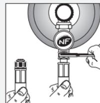
Raccorder l'écrou noir du flexible GPL (avec son joint rouge) au détendeur:
