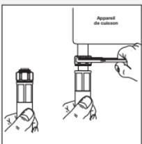
Raccorder l'écrou chromé du flexible GPL (avec son joint noir) à la sortie fileté de l'appareil de cuisson:
