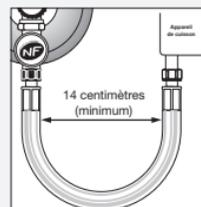
● S'assurer lors de la mise en place définitive de l'installation que le tuyau flexible forme une boucle d'au moins 14 centimètres de diamètre.
