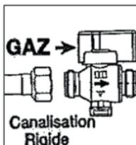
2. Fixer le robinet au mur et le raccorder à la canalisation gaz. Veiller à la présence du joint plat (voir schéma).
