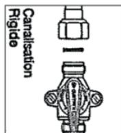
3. Fermer le robinet et visser le raccordement de sécurité (voir schéma). Vérifier le bon positionnement du joint plat.
