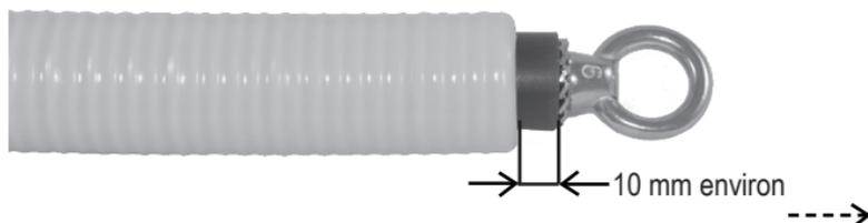
2. Puis, en maintenant le tire-gaine par le jet creux, tourner à fond le boulon à œil dans le sens des aiguilles d'une montre.
