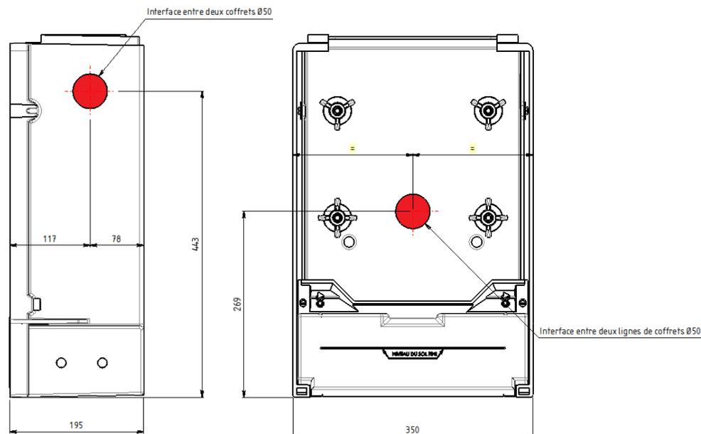
**Le socle contient également** en plus des éléments du socle (visserie, pieds etc.) un raccord à braser pour une entrée cuivre (raccord 2 pièces droit JSC pour Cu14 de référence Gurtner 18172-14).
