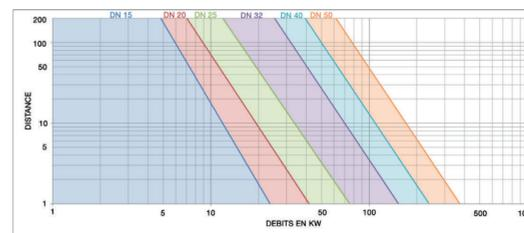
> Débits maximaux en kW pour une perte de charge de 1 mbar maximum
