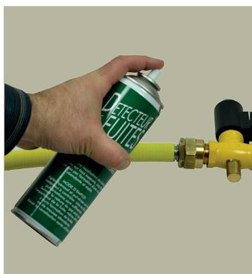
Une fois tous les éléments de l'installation gaz raccordés, procéder à la vérification de l'étanchéité à l'aide de l'aérosol de détection de fuite Gurtner (réf. 14711) ; selon les indications du paragraphe « Contrôle d'étanchéité avant mise en service (DTU 61.1 P3) »
