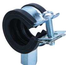
La fixation des canalisations doit être assurée par des colliers de diamètres adaptés aux diamètres extérieurs de tuyaux. Pour éviter tout souci d'écrasement, il est recommandé d'utiliser les colliers de fixation IZINOX®. L'écartement maximal entre chaque collier doit être de 1,5 m sur les parties horizontales et de 3 m sur les parties verticales<sup>3</sup>.
