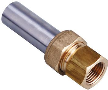
**Caractéristiques techniques**Pression maxi **5 bar**Diamètre Nominal **50**Diamètre (mm) **60,3**Type de raccord **3 pièces**Femelle Rp **2"**Matériau à souder/braser **Acier**
