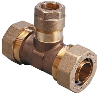
Réf catalogue : **24119****Caractéristiques techniques**Pression maxi **5 bar**Diamètre Nominal **50/32**PE (1) **63**PE (2) **40**PE (3) **63**Type de raccord **monobloc**Norme (1) **NF EN 1555-3****Informations complémentaires**Poids(gr) **3616 g**Long.(mm) **400 mm**larg.(mm) **183 mm**Haut.(mm) **140 mm**
